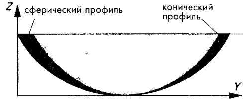
Рис. 4.15. Сравнение профилей сферической и несферической линз
