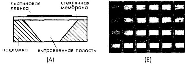
Рис. 14.26. Платиновый болометр: А – стеклянная мембрана над полостью, полученной методом травления, Б – матрица из болометров
