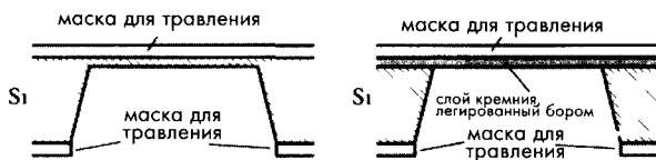
Рис. 18.12. Изготовление диафрагмы или мембраны
