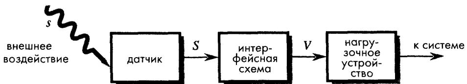
Рис. 5.1. Интерфейсная схема согласует форматы сигналов датчика и нагрузочного устройства.
