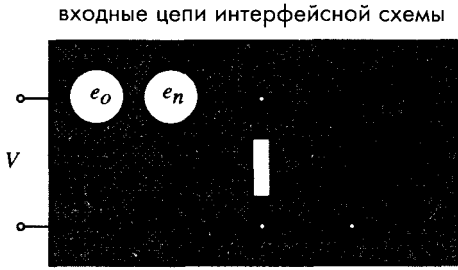
Рис. 5.3 Эквивалентная схема, учитывающая источники помех во входных цепях интерфейса
